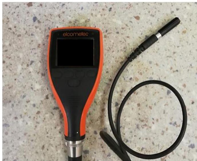
Slika 57. Uređaj za mjerenje debljine suhog filma „Elcometer 456“
