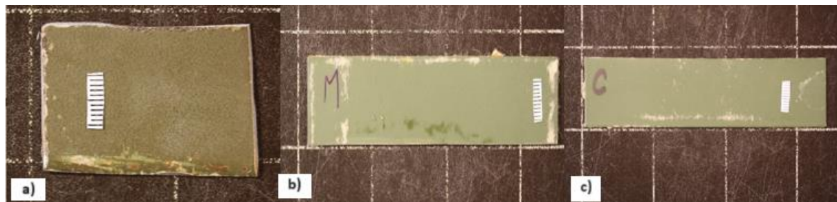
Slika 86. Izgled površine nakon elektrokemijskog ispitivanja za: a) uzorak A1-6, b) uzorak M1-4, c) uzorak C1-5
