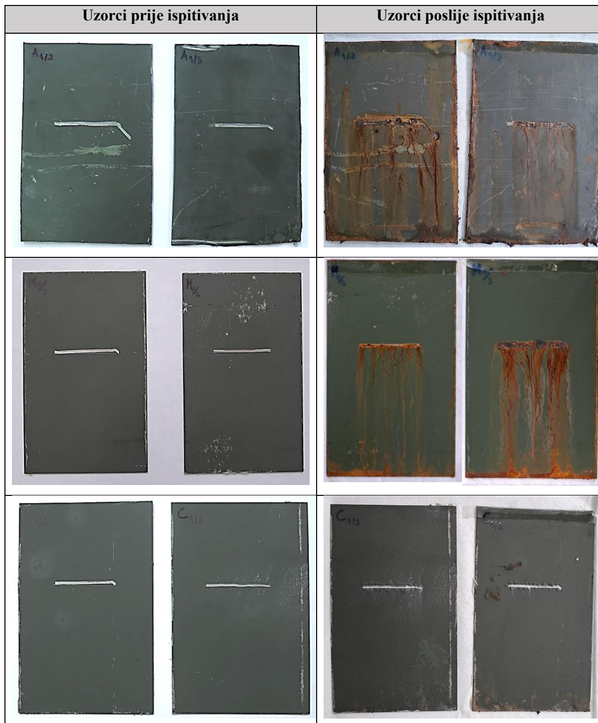
Slika 75. Uzorci prije i nakon ispitivanja u slanoj komori
