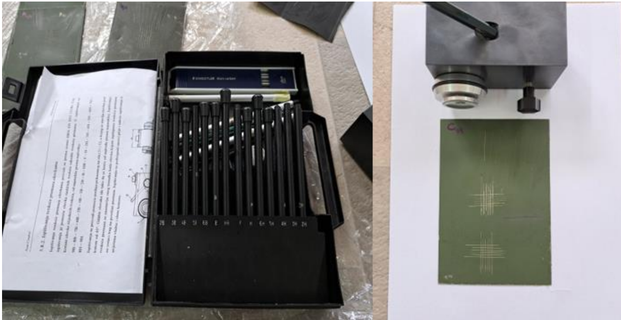
Slika 60. Oprema za ispitivanje tvrdoće premaza olovkom
