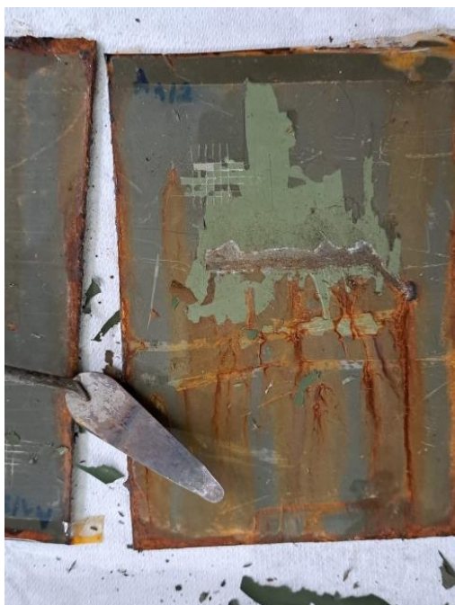
Slika 76. Priprema uzorka za mjerenje stupnja korozije
