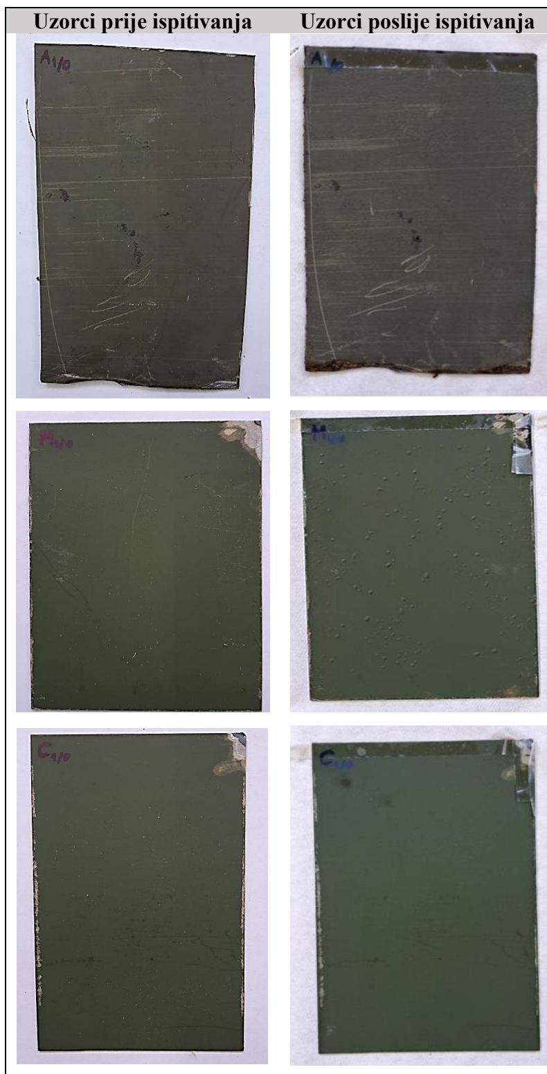
Slika 77. Uzorci prije i nakon ispitivanja u vlažnoj komori
