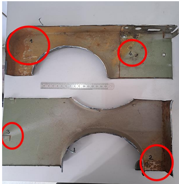
Slika 72. Oblici korozije na unutrašnjoj strani lima vrata vozila
