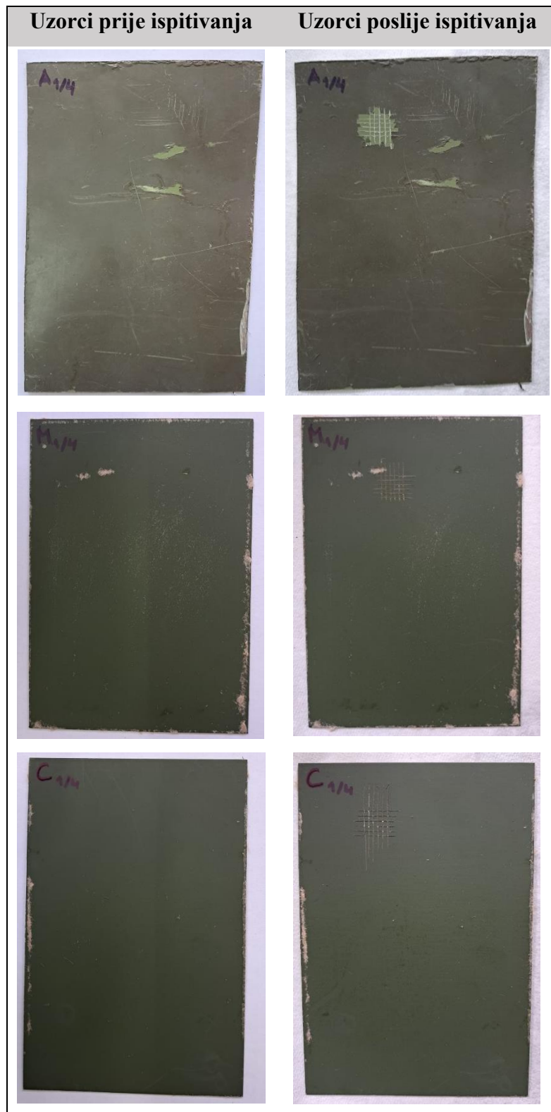
Slika 78. Uzorci prije i poslije ispitivanja u klimatizacijskoj komori
